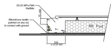
2 <u>Garage door step</u> <u>CONSTRUCTION DETAIL</u>
